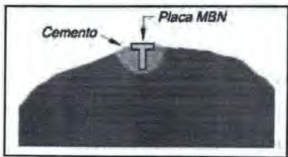
Figura 13. Monumentación de deslindes en terrenos duros.
