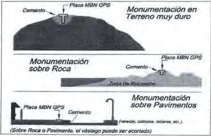
Figura 8. Monumentación sobre roca y pavimentos.
