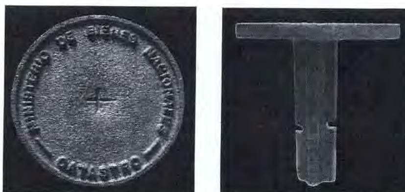
Figura 5. Placa utilizada en la monumentación de los Vértices de Vinculación MBN.
